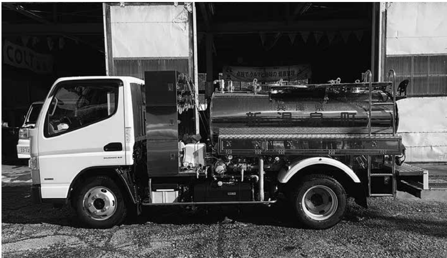
災害時や断水時における安心で安定的な水供給のために購入された給水車。積載量はポリタンク(20ℓ)200個分の4トン。
